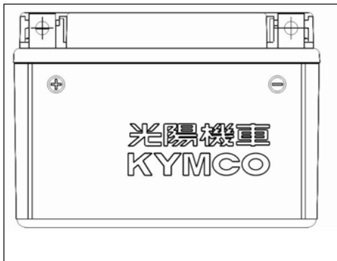
Batería sin mantenimiento
